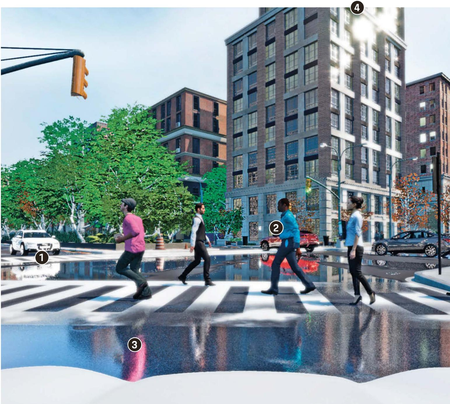
**Täuschend echt:** In die PEVATeC-Simulationen lassen sich dynamische Objekte wie virtuelle Fahrzeuge (1) und Fußgänger (2) einbinden. Dank „Physically Based Rendering“ ist der synthetische Input für die Sensoren nicht von der Wirklichkeit zu unterscheiden. Das zeigt sich unter anderem bei den Lichtreflexionen auf nasser Fahrbahn (3) und auf spiegelnden Oberflächen wie Fenstern (4). Entscheidend ist es, dass die Verteilungsmuster des Lichts physikalisch korrekt dargestellt werden.
