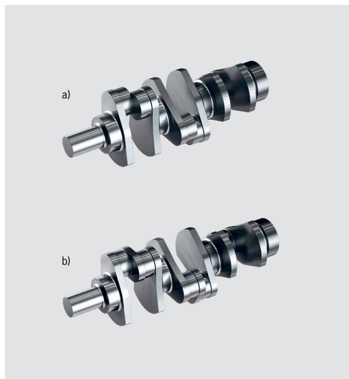
Split-Pin-Kurbelwelle V6 (a) und V6-Kurbelwelle mit Flying Arms (b)
