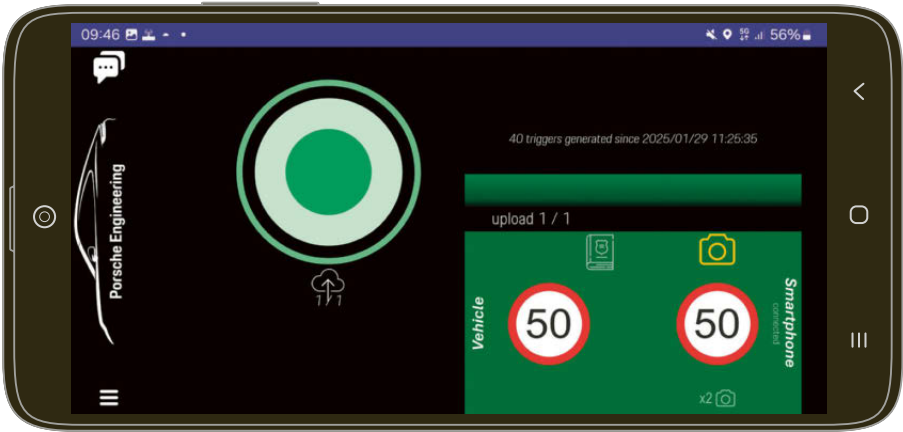
Verkehrszeichen korrekt erkannt: Grüne Flächen signalisieren, dass die Ergebnisse des Fahrzeugs und der ComBox-App übereinstimmen.
