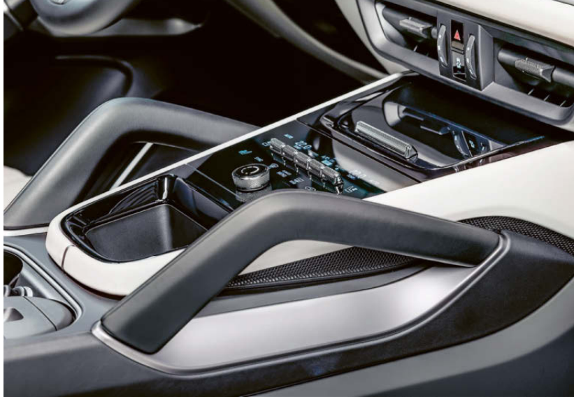
Gut zugänglich: Da sich der Automatikwählhebel auf der Armaturentafel befindet, wird in der Mittelkonsole Platz für Ablagen und für eine große Klimabedienfläche frei.
