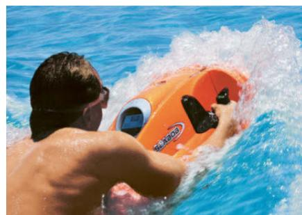
**体育器械:** 冲浪艇品牌 Cayago 的 Seabob 采用保时捷工程公司的蓄电池技术, 开创性地使用了叶轮驱动。
