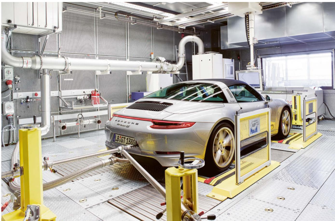
检测与排放相关的状况：针对新车型的型式测试，保时捷工程会在底盘测功机上对汽车进行多达 80 次的测试。
