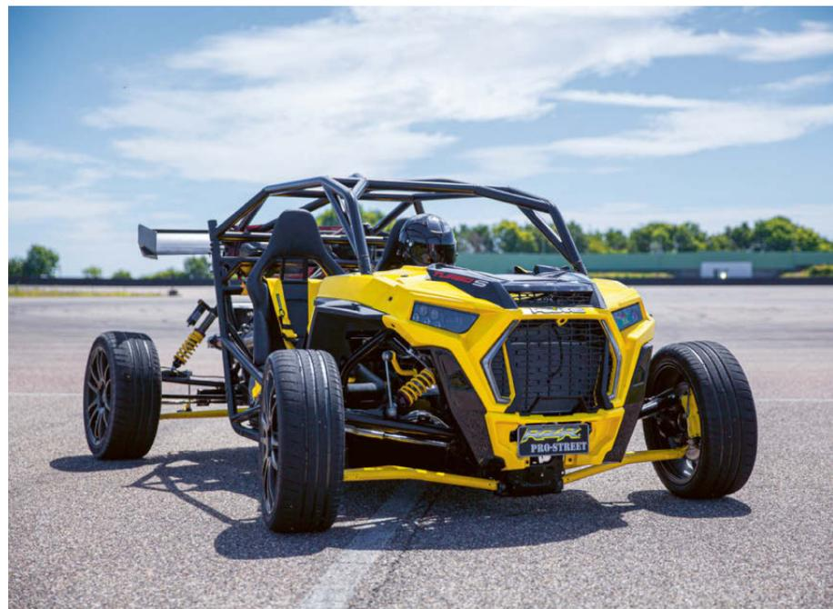
**Stabile Straßenlage:** Der Pro-Street RZR bekam neue Federbeine mit einem optimierten Winkel. Gemeinsam mit den speziell abgestimmten Dämpfern, einer veränderten Querenkergeometrie, neuen Stabilisatoren und 18-Zoll-Felgen verhelfen sie dem Fahrzeug zu einer breiteren Spur.
