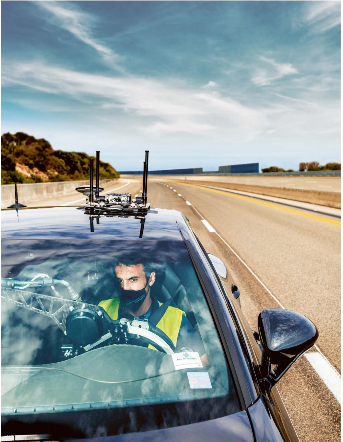
**Komplett vernetzt:** Das NTC-Versuchsfahrzeug ist mit vier WLAN- und zwei GPS-Antennen ausgestattet. Sie dienen der Vehicle2vehicle-Kommunikation beziehungsweise der präzisen Lokalisierung.
