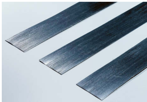
钢性更高： 俯视仅 0.2 厘米薄的胶带条。碳纤维的单条纤维呈连续纵向走向，刚度比 PP-GF x 高出 20 倍。
