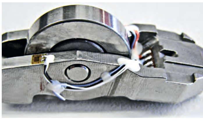
DMS-Applikation Belastung Rollenschlepphebel
