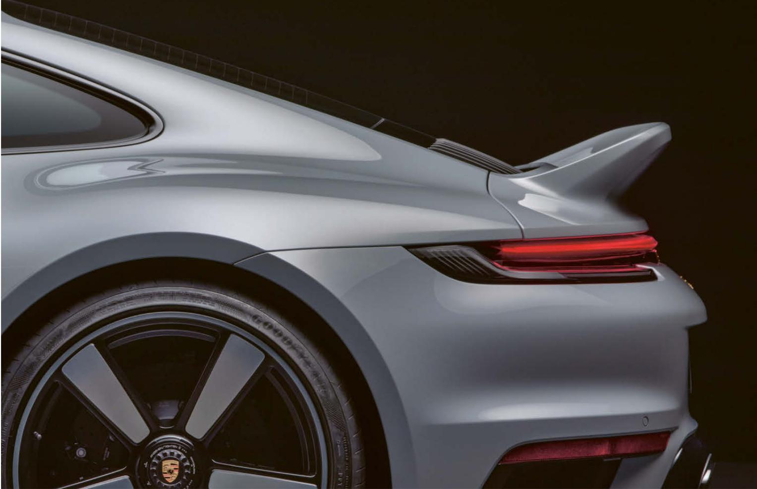
与众不同：采用碳纤维增强塑料 CFRP 制成的扰流板，沿用了 1972 年 911 RS 2.7 的“鸭嘴”形状。
