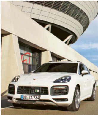
准备就绪，步入实际测试：除了标准传感器外，三辆 Jupiter 测试车辆在前部和后部还都配备有光学雷达，此外还附有立体深度摄像头和高性能计算机。
