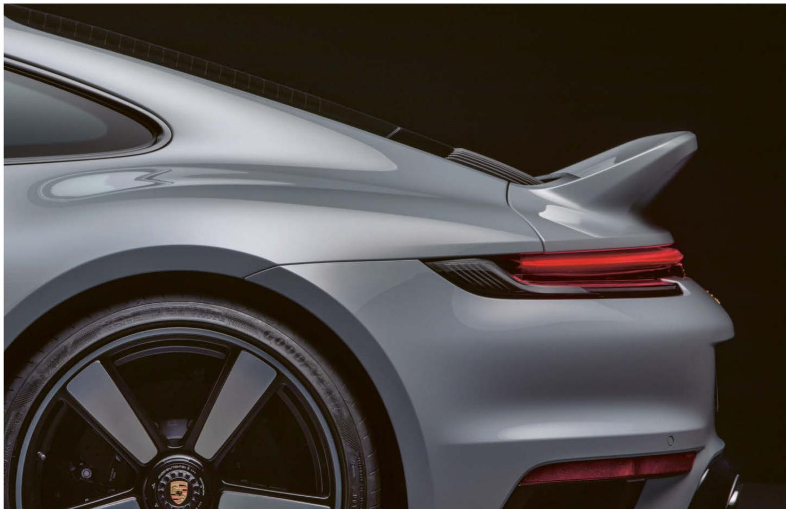
**Unverkennbar:** Der Spoiler aus kohlefaserverstärktem Kunststoff CFK greift die Form des „Entenbürzels“ des 911 RS 2.7 von 1972 auf.
