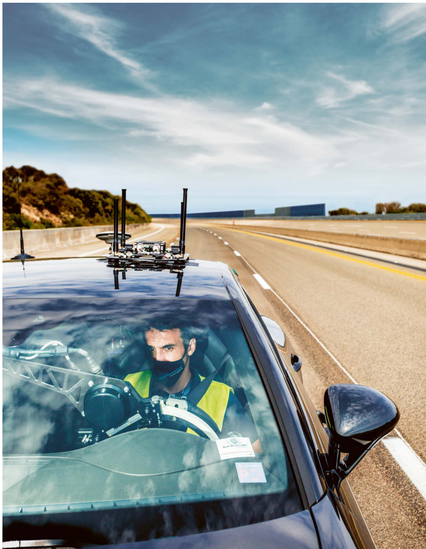
全面互联：NTC 测试车辆配备了四个无线网天线和两个 GPS 天线，用于车车通信以及精确定位。
