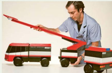
**Modulares Konzept:** Das O.R.B.I.T.-Grundfahrzeug sollte sich mit verschiedenen Ergänzungseinheiten kombinieren lassen – darunter ein Teleskop-Hubrettungssystem mit Liftfunktion.
