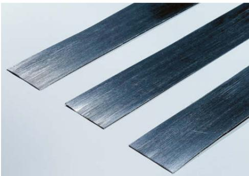
**Erhöhte Steifigkeit:** Draufsicht auf die nur 0,2 Millimeter dünnen Tapestreifen. Die Carbonfaser-Filamente laufen ohne Unterbrechung in Längsrichtung, wodurch sich die Steifigkeit gegenüber PP-GF<sub>x</sub> um den Faktor 20 erhöht.
