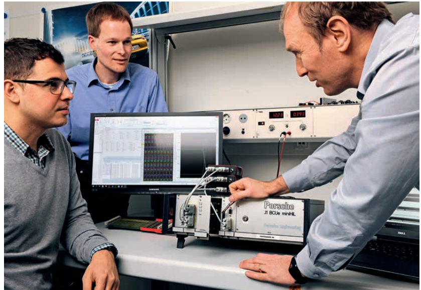
Volle Variabilität: Ein Entwicklerteam passt das Mini-HiL an eine neue Hardware an. Dazu müssen lediglich die Steckkarten ausgetauscht werden.
