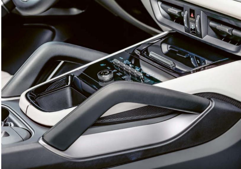
**操作便利:** 自动变速箱换挡杆设置于仪表盘上,由此预留出的中控台空间现在放置了储物格和一个大型空调控制器。
