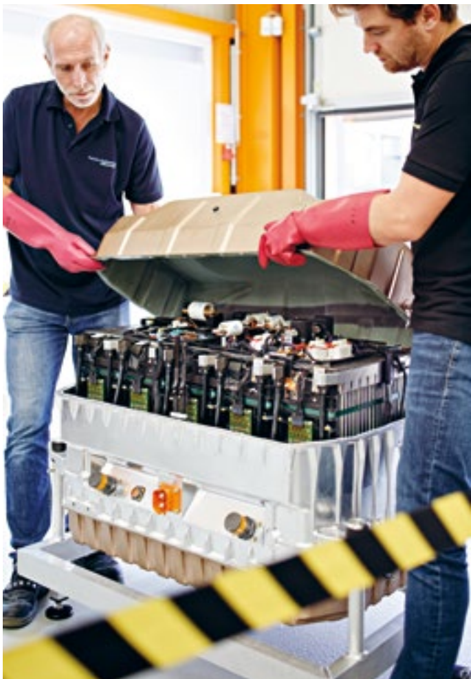
Die Hochvoltbatterie des Forschungsprojekts wurde von Porsche Engineering ausgelegt und entwickelt.
