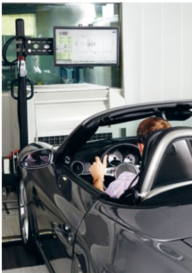
Kalibrierung eines Fahrzeugs auf dem Rollenprüfstand
