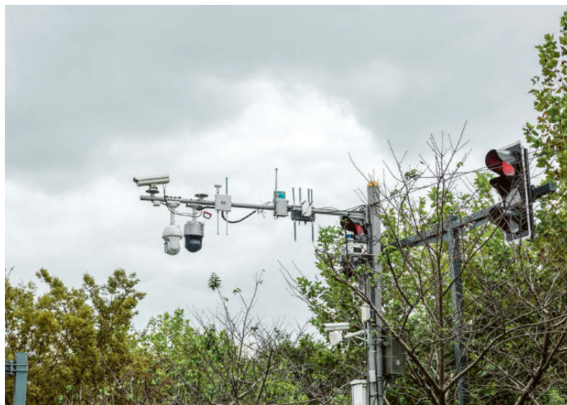
Vernetzung: Im HAF-Testareal in Shanghai kommen Funkmodule sowie LiDAR-Sensoren zum Einsatz.
