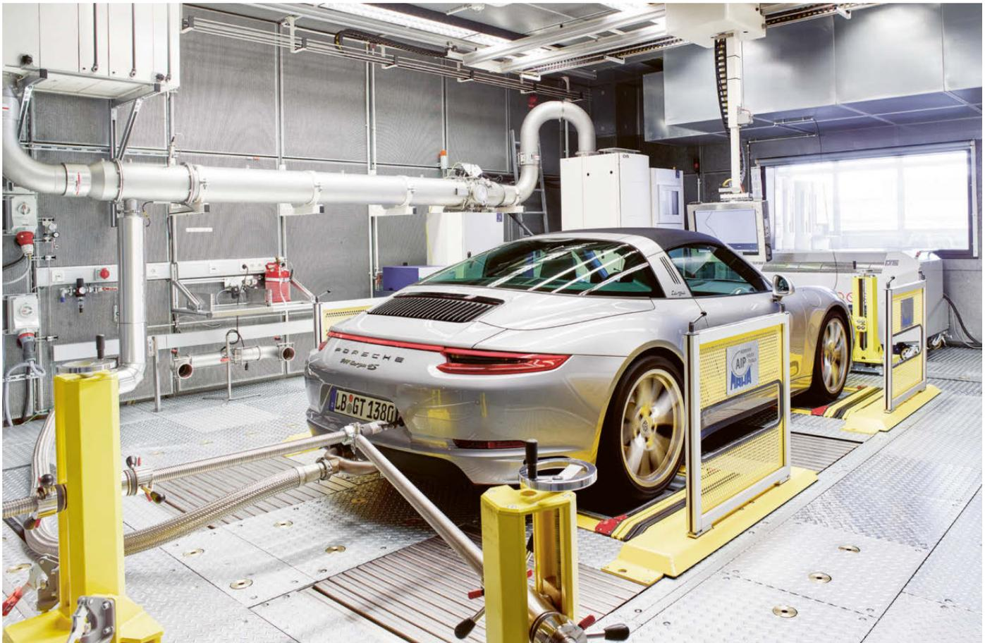
**Untersuchung emissionsrelevanter Ereignisse:** Für die Typisierungstests eines neuen Fahrzeugmodells führt Porsche Engineering auf dem Rollenprüfstand bis zu 80 Prüfläufe durch.
