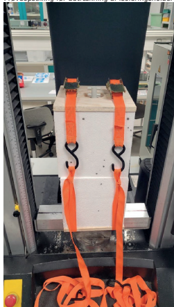
Prøveopstilling for udtrækning af isoleringsholder
