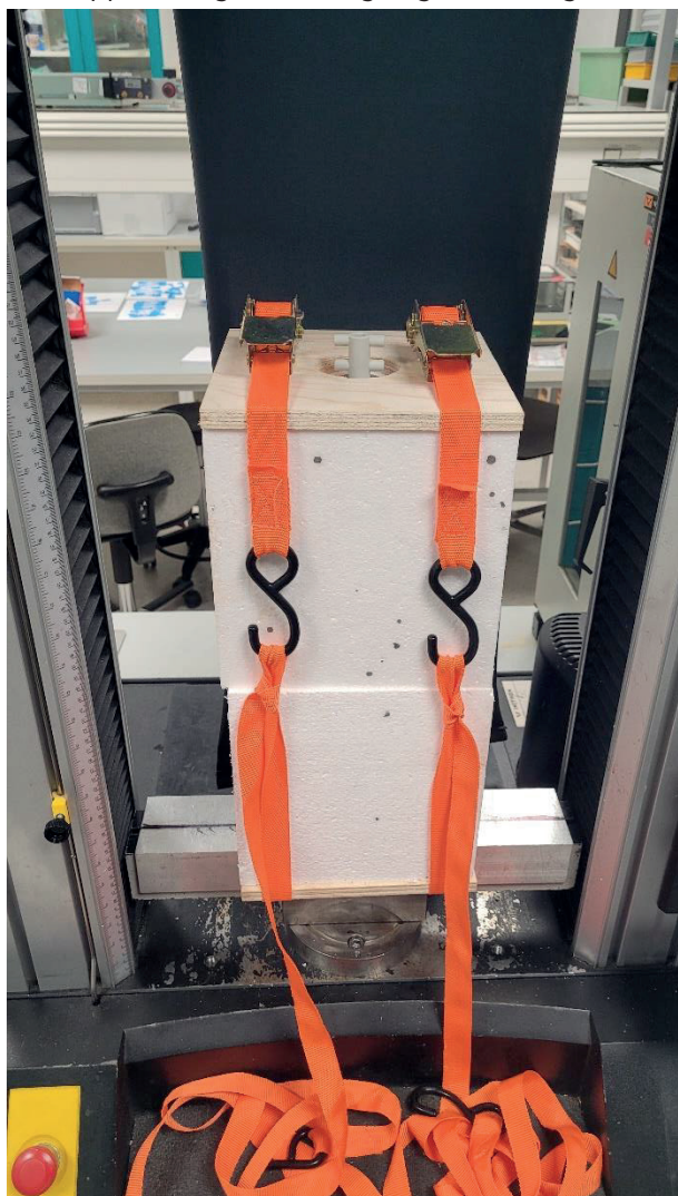
Provpuppställning före utdragning av isoleringshållare
