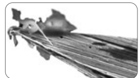
Naald na meerdere keren gebruiken, met deels aanhangende weefselresten
