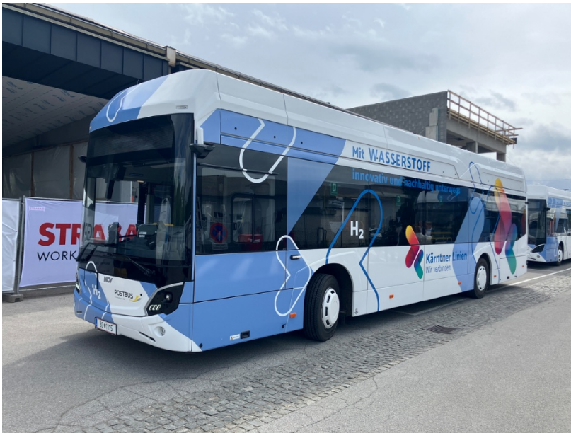
Niederflur-Überlandbus Typ MCV C127 FC LE der Österreichischen Postbus AG, ausgestattet mit elektrischem Antriebssystem VEDS 1.0 von Driventic.
