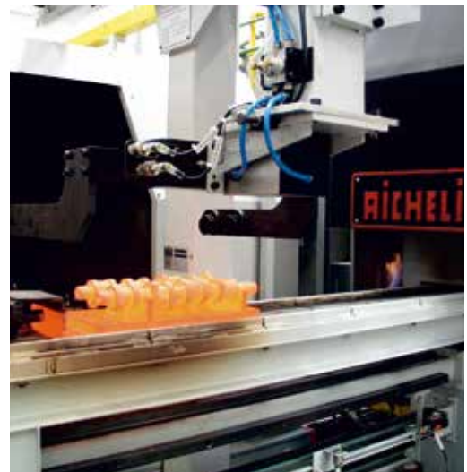
Rotationshärten von aufgekohlten TDI-Nockenwellen mit anschließendem Waschen und Anlassen.
