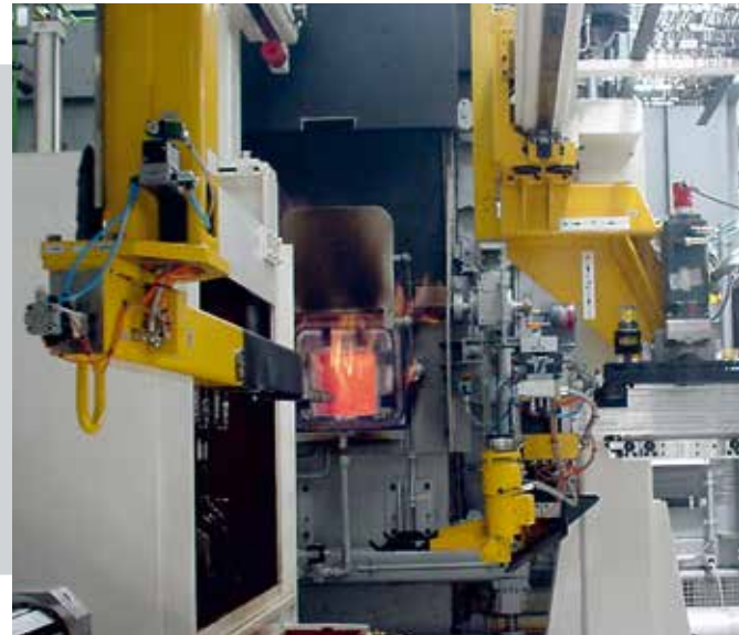
Aufkohlen und Rotationshärten von Wellen und Achsen.
