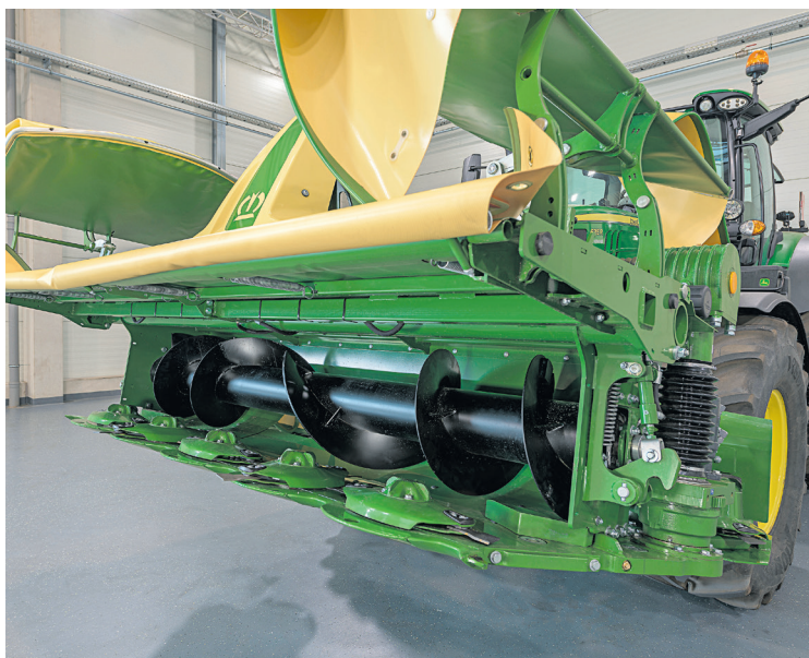
Innovativ: Die Krone Frontmäherwerke bei allen Arbeitsbreiten auf Option mit Schnecken Schwadablage
