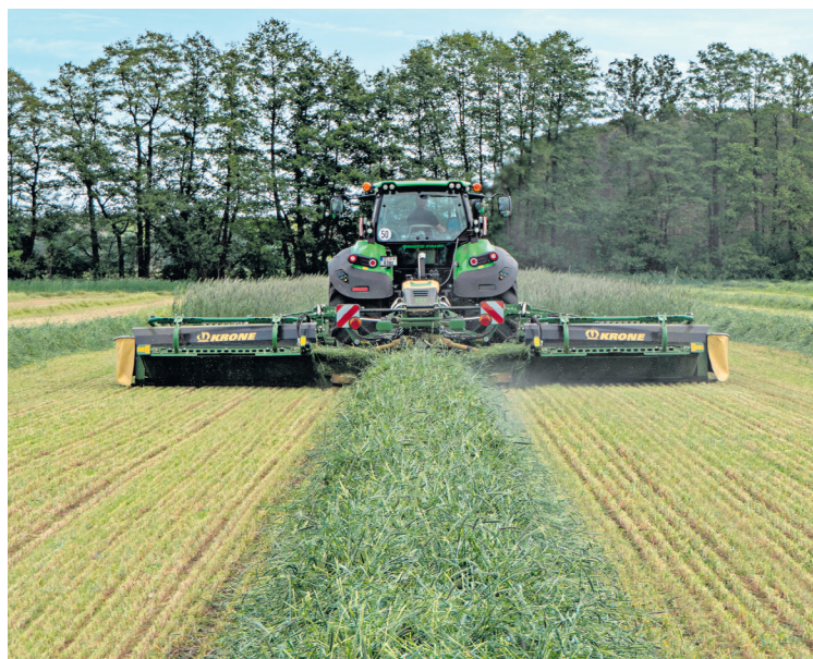
Das Krone Tripelmähwerk mit Schwadablage erfreut sich immer größerer Beliebtheit bei den Anwendern.
