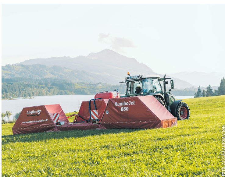
Rumbojet ermöglicht schlagkräftige Ampferbekämpfung mittels Spotspraying
