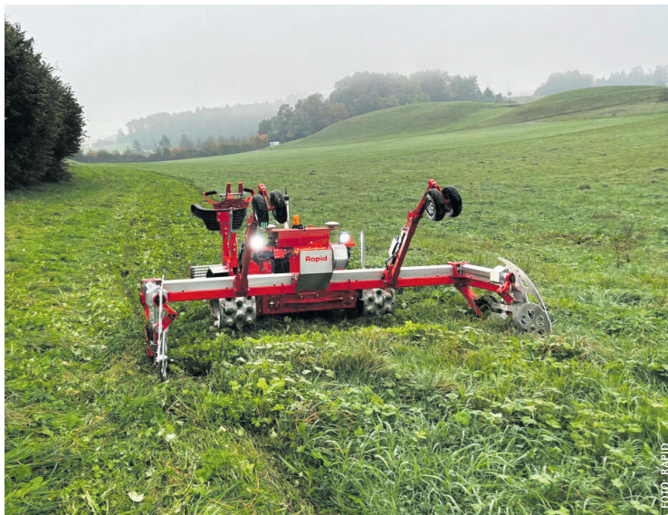
Der elektrisch angetriebene Rapid Cosmos mit Doppelmessermähwerk
