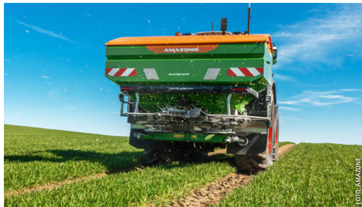
Eine der 2025 ausgezeichneten Innovationen: ZA-TS 01 AutoSpread ermöglicht die autonome Streuereinstellung durch Messung des tatsächlichen Streubildes.
