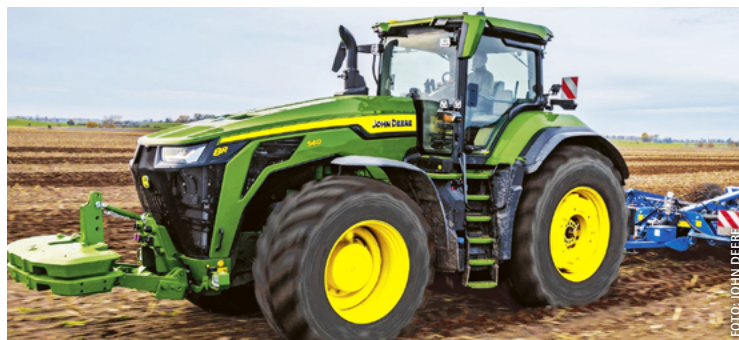
Bis zu 634 PS stellt der 13,6-Liter-Motor beim 8R/8RX zur Verfügung.
