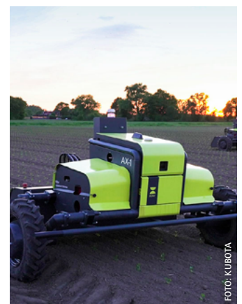
Der AX-1 dient zur punktgenauen Pflanzenschutzmittelapplikation.
