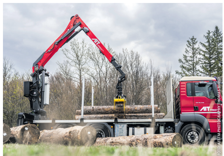
Im Projekt FutureWoodTrans wurden Roboter-Hebesysteme zum Laden von Holz entwickelt. Beforscht wurde auch die vollautomatisierte Lkw-Fahrt.
