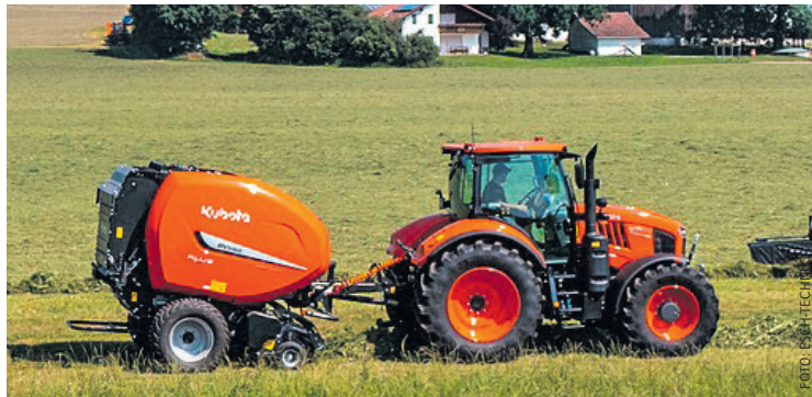
Die Ballenpresse BV5160: 2,20-m-Pick-up mit doppelter Kurvenbahn
