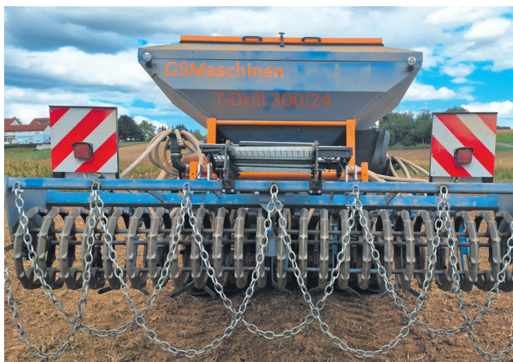
Die gebrauchte Trapezpackerwalze sorgt für die nötige Rückverdichtung.
