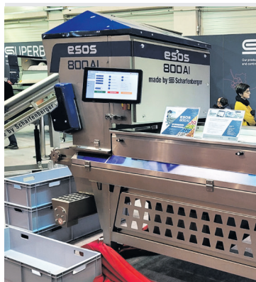
KI-gestützte Sortierung der Trauben mit ESOS 800 AI von Scharfenberger
