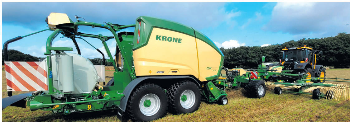
Die Weltpremiere mit der Swadro BaleTrain TC 880 Pro: Schwaden und Pressen in einem Arbeitsgang wird möglich.
