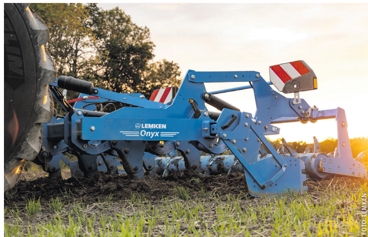
Onyx: Auch bei maximaler Arbeitstiefe genügend Freiraum zum Grundrahmen.
