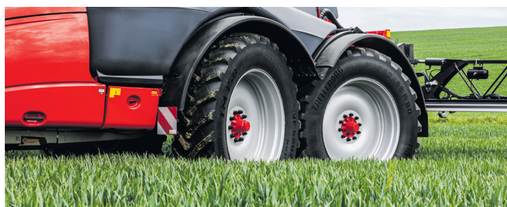
Für Tandem-Maschinen gibt es künftig DynamicSteering . Die Lenksoftware wechselt automatisch zwischen spurgetreuer und verschleißbarmer Lenkung.
