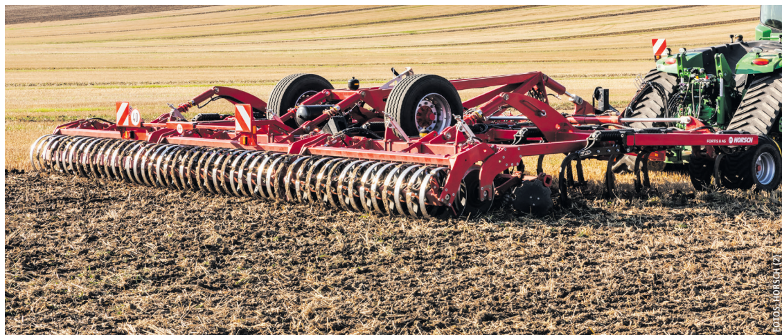
Mit einer Arbeitsbreite von 8,27 Metern ermöglicht Fortis 8 AS – mit entsprechenden Traktoren – hohe Flächenleistung.
