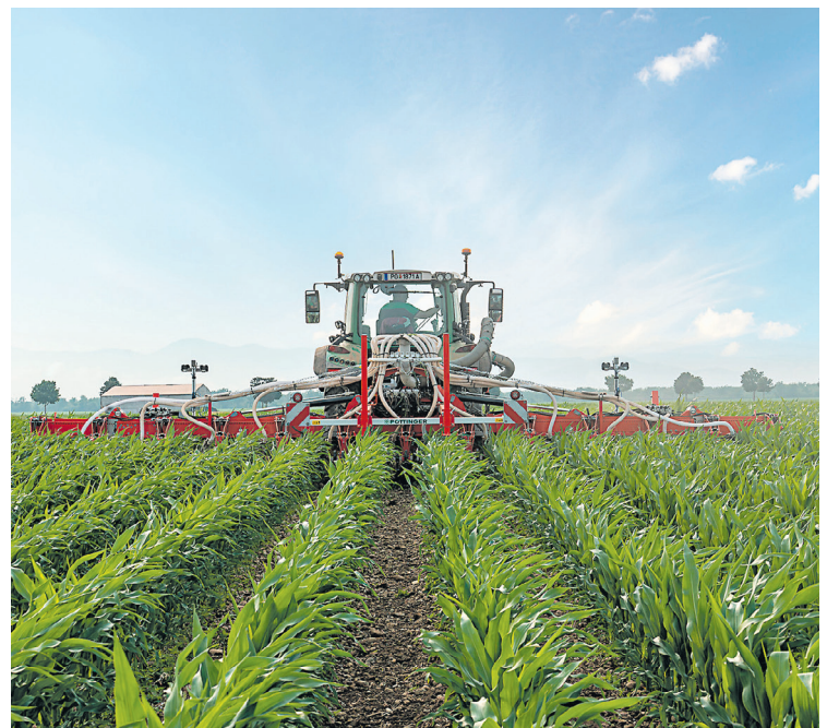
Das vielseitige Hackgerät FLEXCARE V dient der mechanischen Beikrautregulierung zwischen den Reihen.
