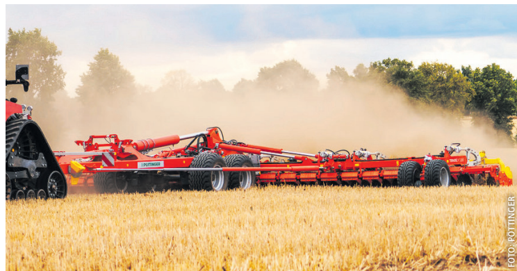
Die Terradisc HT 12000 ist für Traktoren zwischen 450 und 720 PS ausgelegt.
