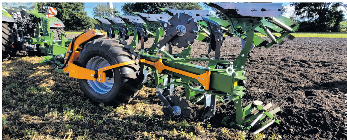
Eines der vielen neuen Geräte für die Bodenbearbeitung: der sechsscharige Aufsattel-Volldrehpflug Tyrok 400
