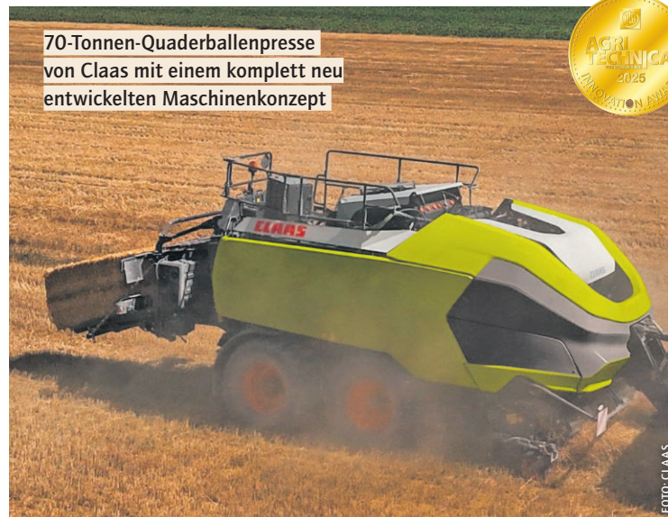
„Line Traction“ ersetzt Differenziale durch Hydrostatik in den Planetenendrieben.
