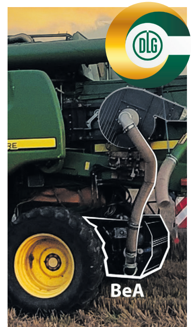
Zürn Seed Select: Unkrautsamen werden bei der Ernte gesammelt und abgetötet.
