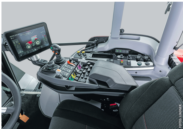
Die LDrive-Armlehne mit zusätzlichem Touch-Bildschirm und neuem Joystick
