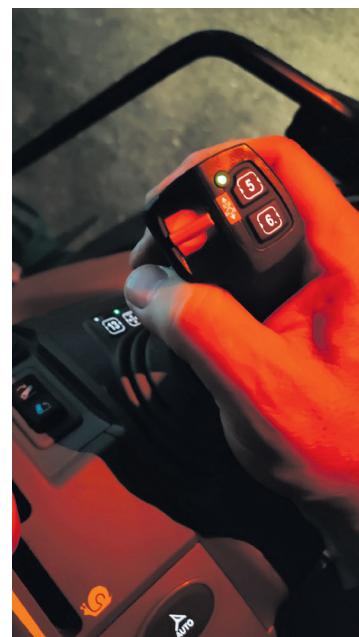
Der gesicherte Hebel nimmt erst nach Umfassen Befehle an.
