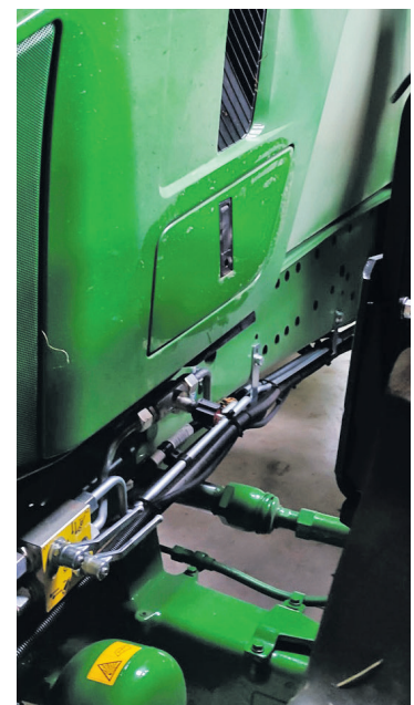
Separate Wartungsklappe zur Motorölstandskontrolle
