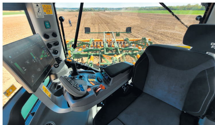
Der drehbare Sitz mit iControl-Armlehne, iMonitor 5, iMotion- und Kreuzhebel-Joystick ermöglicht bequeme Übersicht über das Anbaugerät.
