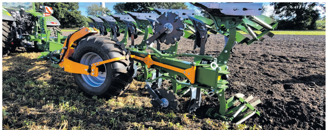
Eines der vielen neuen Geräte für die Bodenbearbeitung: der sechsschichtige Aufsattel-Volldrehpflug Tyrok 400
