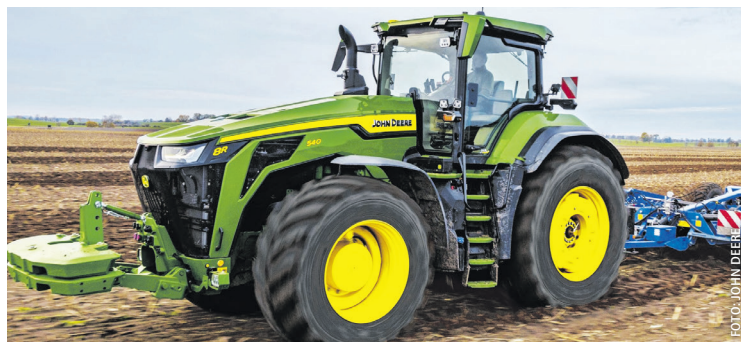
Bis zu 634 PS stellt der 13,6-Liter-Motor beim 8R/8RX zur Verfügung.
