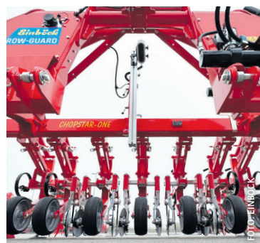
Der Rahmen hat einen Verschiebeweg von insgesamt 380 Millimetern.
