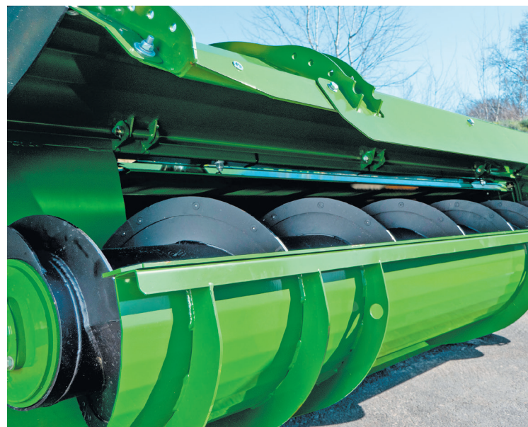
Krone Schwadablage mit Schnecke seit mehr als 25 Jahren im Selbstfahrmäher Big M bewährt. Findet jetzt optional Anwendung in allen Krone Mähwerken.
