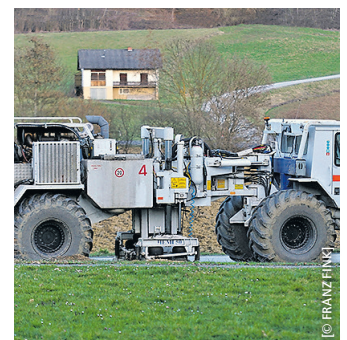
Ein Seismik-Truck im Raum Kirchbach-Zerlach.
