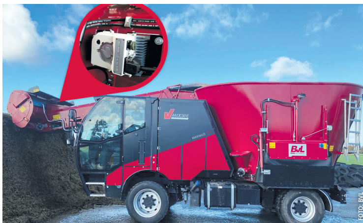
Der NIR-Sensor am Entnahmearm des Selbstfahrers V-MIX Drive von BvL
