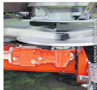
Technische Lösung für optimale Drehzahlregelung der Scheiben
