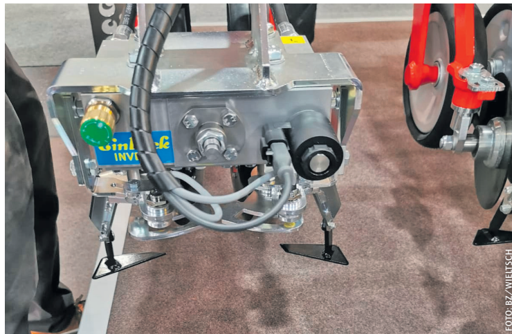
Unscheinbares Herzstück der Invera: der Hydraulikblock samt Messern
