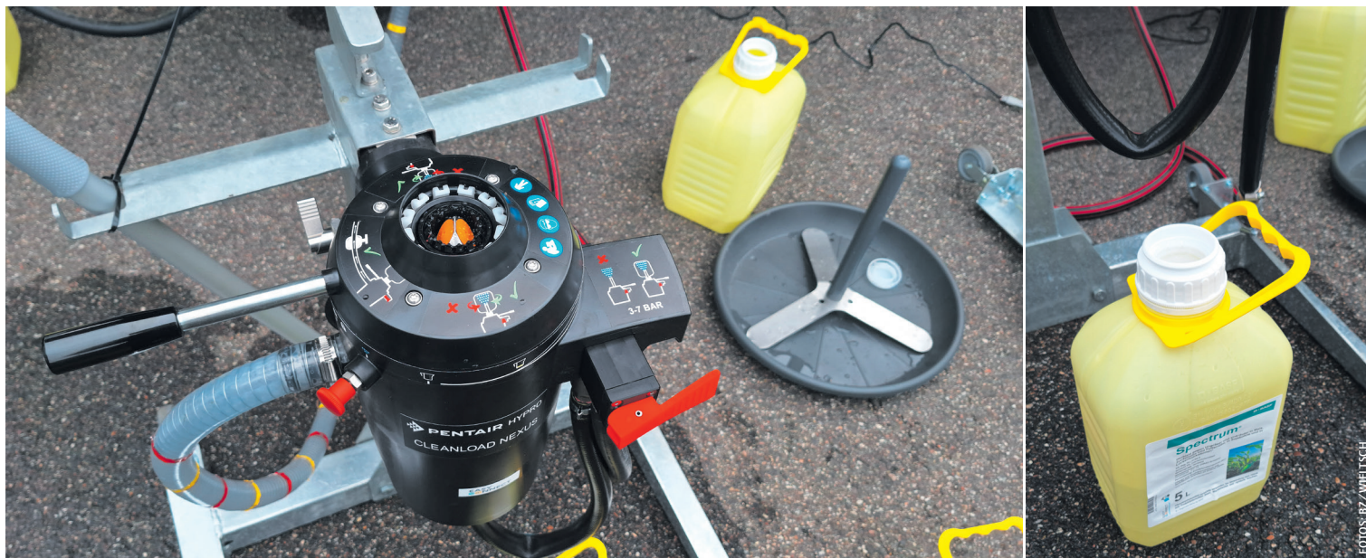
Die Couplergeräte sind manuell, voll- und teilautomatisch erhältlich. Die Einspülschleuse hat ausgedient. Eine manuelle Verwendung der Gebinde ist möglich.
