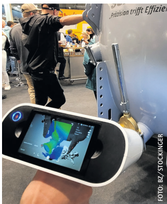
Für passgenauen Anbau wird das Fass gescannt.
