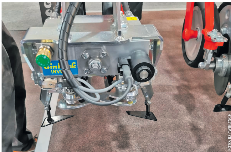
Unscheinbares Herzstück der Invera: der Hydraulikblock samt Messern
