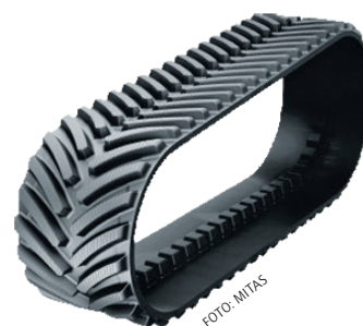
Gummiraupen reduzieren den Bodendruck.
