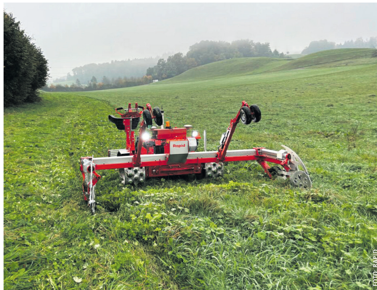
Der elektrisch angetriebene Rapid Cosmos mit Doppelmessermähwerk
