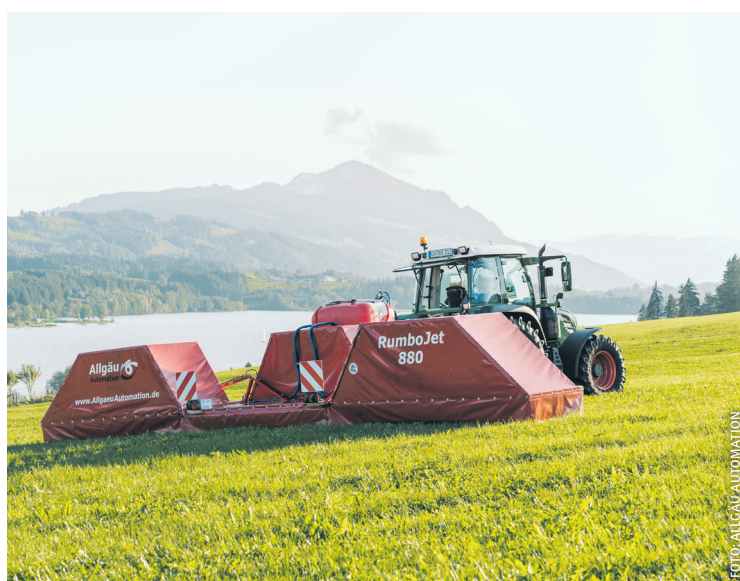
RumboJet ermöglicht schlagkräftige Ampferbekämpfung mittels Spotspraying
