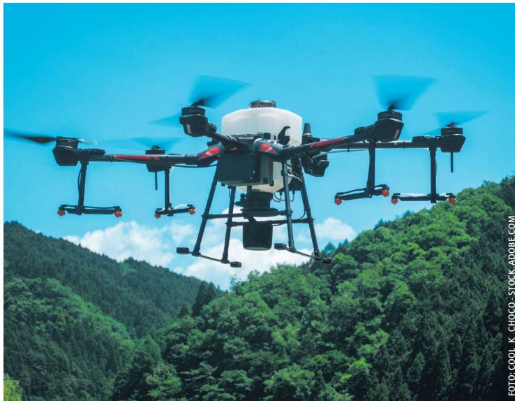
Mit Agrardrohnen können Steilflächen effizient behandelt werden.
